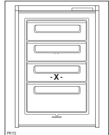
Zur Ausnutzung des gesamten Nutzvolumens und zum einlagern größerer Teile können die mit -X- bezeichneter Schubladen/Körbe entfernt werden (s. Skizze).
